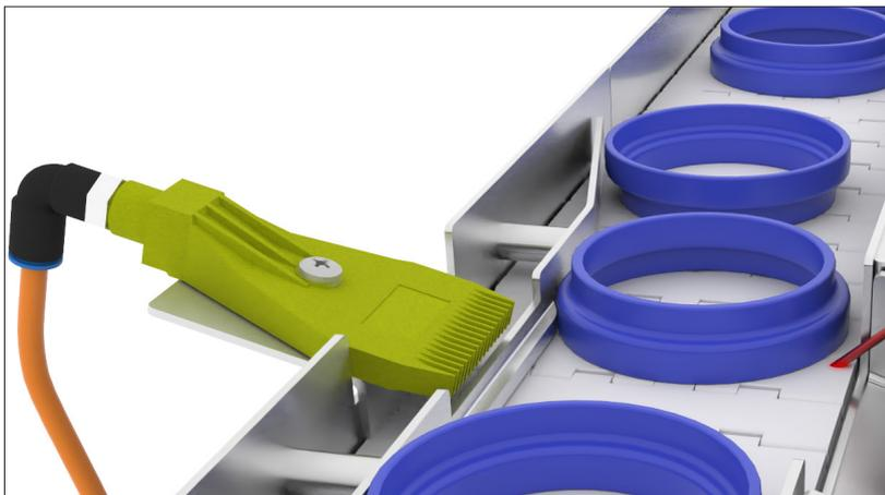
El pequeño punto láser de luz roja redondo de 1 mm altamente visible se alinea en la cinta transportadora blanca y se programa en el modo de supresión de primer plano para detectar la cinta. Si una pieza está colocada al revés y, por lo tanto, su diámetro mayor descansa directamente sobre la cinta, impidiendo al sensor que detecte la cinta, se activa la boquilla de soplado y se devuelve la pieza al recipiente vibratorio.
